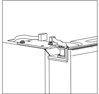
3. Entfernen Sie die Schrauben des oberen Scharniers.
