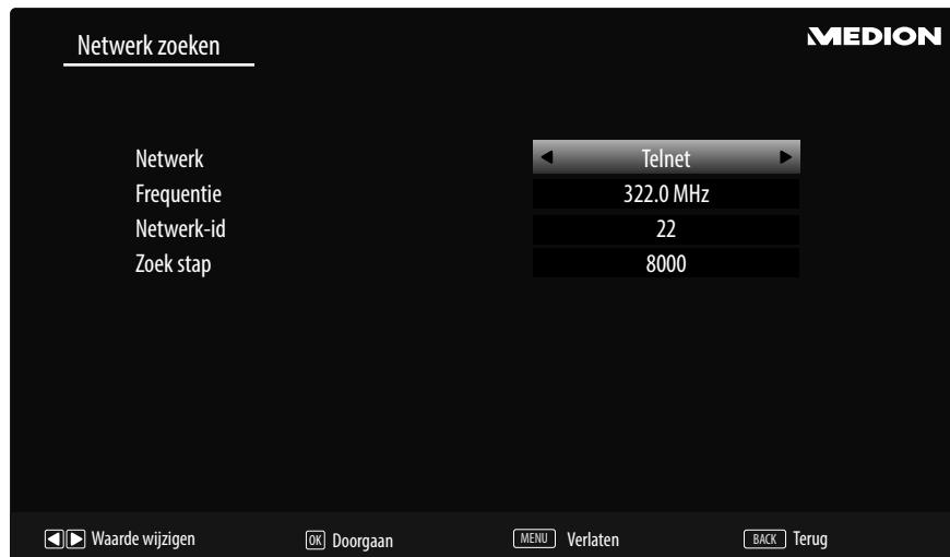
Wanneer u eerder de ontvangstmethode **DIGITALE KABEL** heeft geactiveerd, kunt u nu nog de instelling voor zoeken via het netwerk aanpassen. Wanneer het nodig mocht zijn, kunt u hier de **NETWERK**, de **FREQUENTIE** en de **NETWERK-ID** aanpassen.
