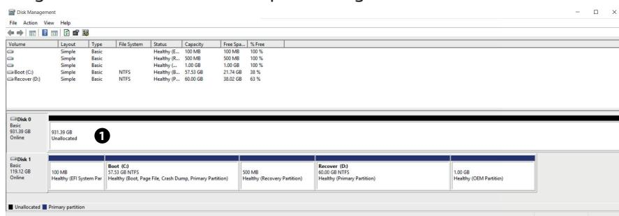
Nella parte inferiore della finestra ① si vede il disco rigido supplementare.
