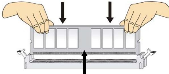
10. Drücken Sie die untere Kante des DIMM in den Sockel.
