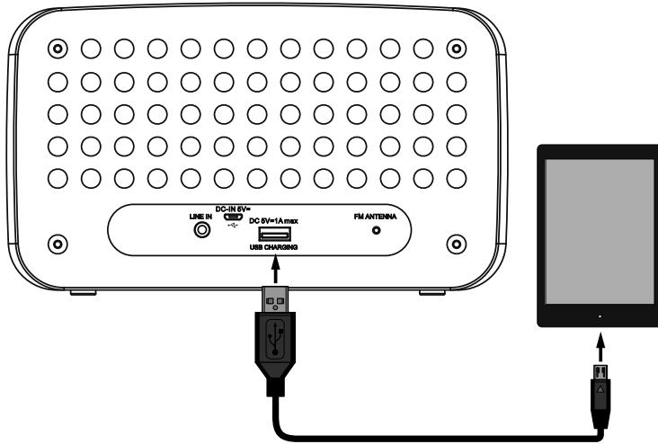
U kunt mobiele apparaten met behulp van een USB-kabel opladen via de USB-aansluiting.
