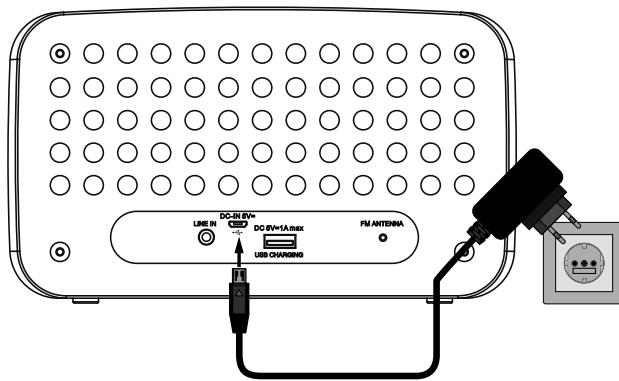
Nachdem alle anderen Komponenten angeschlossen sind, nehmen Sie den Anschluss des Netzkabels vor.
