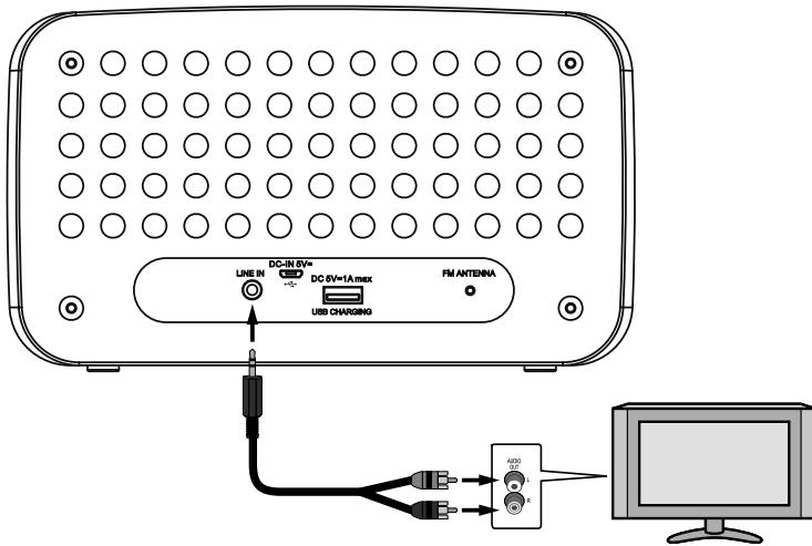
Vous pouvez raccorder un appareil externe (p. ex. un téléviseur) pour en transférer le son. Vous avez pour cela besoin d'un câble de connexion jack 3,5 mm.
