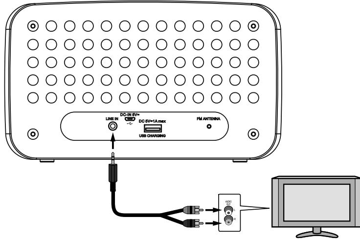
U kunt een extern apparaat (bijvoorbeeld een tv) aansluiten voor de overdracht van geluid. Daarvoor heeft u een verbindingskabel met 3,5 mm klinkaansluiting nodig.
