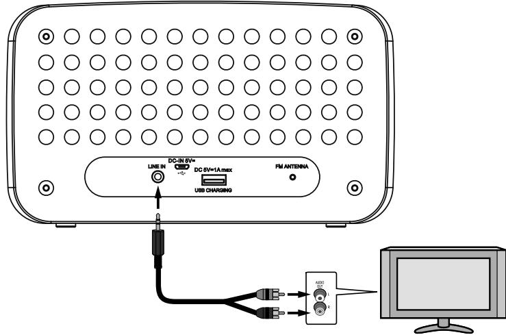
Sie können ein externes Gerät (z. B. ein Fernsehgerät) zur Tonübertragung anschließen. Dazu benötigen Sie ein 3,5mm Klinke-Verbindungskabel.
